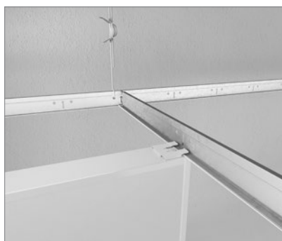
Rockfon Universal Baffle fijado correctamente a un perfil T24 (ambas pestañas quedan por encima de la base de la T24).
