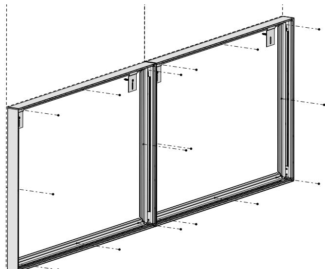
**6** Fije los marcos entre sí verticalmente con tornillos autoperforantes para evitar que queden huecos.
