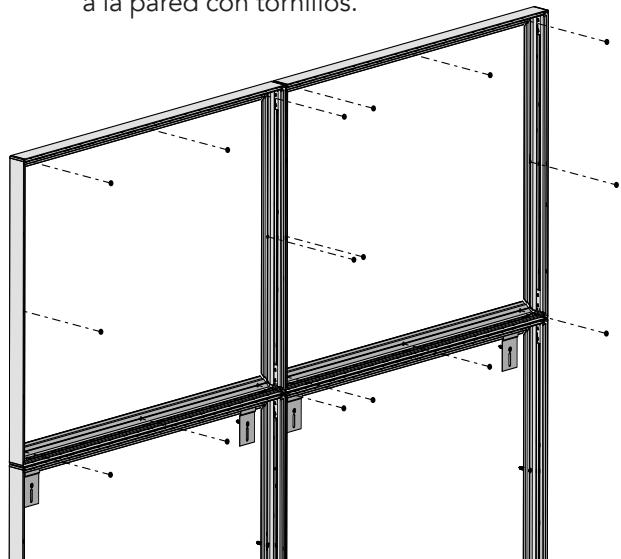
**8** Fije los marcos entre sí (horizontal y verticalmente) con tornillos autoperforantes para evitar huecos.
